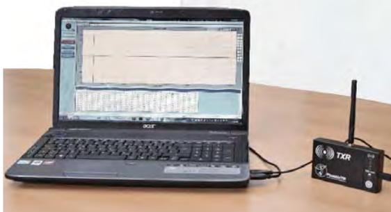
Der TX1001 Koordinator wird an einen freien USB Anschluß des PC's angesteckt und überträgt so die empfangenen Daten an die Thermal View Plus Software. Hier werden die gemessenen Temperaturen graphisch und tabellarisch dargestellt und ausgewertet. Der Prozess kann in Echtzeit beurteilt werden; Veränderungen der Ofeneinstellungen werden sofort sichtbar.
