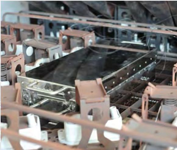
Der Datenlogger läuft, genau wie bei einem System ohne Telemetrie, in einem Hitzeschutzbehälter durch den Ofen hindurch. Die Temperaturdaten werden im Datenlogger gespeichert und gleichzeitig via Funk aus dem Ofen übertragen. Das ZigBee Funkprotokoll erlaubt auch bei der Funkübertragung einen schnellen Messtakt von einer Sekunde bei maximal 20 Messfühlern.
